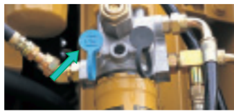
作動油およびエンジンオイルチェックが 容易なSOSサンプリングバルブ
