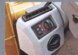
外気導入/内気循環切替機能付エアコン ディショナ(902C2/903C2にオプション)
