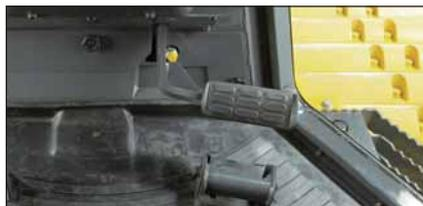
**デセルモード:** デセル/ブレーキペダルを踏むと、走行速度とエンジン回転数が下がります。一般的作業時に使用します。
