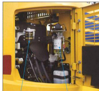
高効率燃料フィルタ ウォーターセパレータ機能付燃料プレフィルタ
