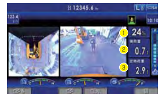
① 負荷率表示 ② 実荷重 ③ 定格荷重
