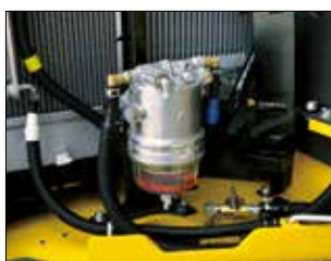
ウォータセパレータ機能付燃料プレフィルタ
