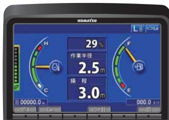
作業半径・揚程・負荷率表示
