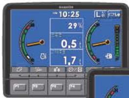
実荷重・定格荷重・ 負荷率表示
