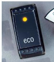
エンジン回転を低く制御して、燃料消費量を10%抑えます。砂利や雪などを対象とした軽作業などでより効果を発揮します。
