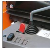
作業機の操作レバーをロックする安全機構です。オプションの3連用レバーにもレバーロックが装備されます。
