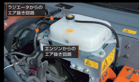
エキスパンションタンク
