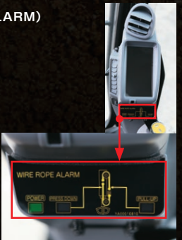
ロープ異常警報装置
